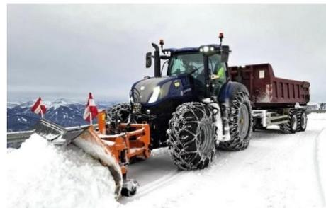
**Traktor New Holland T7.245 300 PS mit Schneefräse Zaugg 110 cm**
